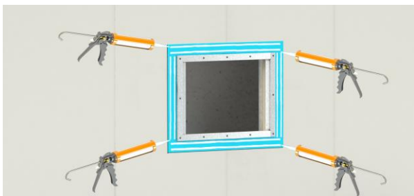
1. Applicera Kiilto Keraseal på ramens prefabricerade foliefläns.
