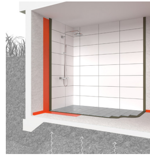
BILD A – Källare med tillskjutande markfukt
