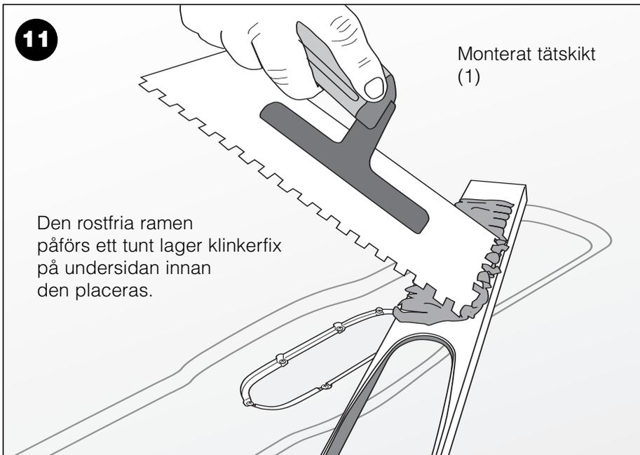
Tätskiktet (1) monteras efter tätskiktsleverantörens monteringsanvisningar.
