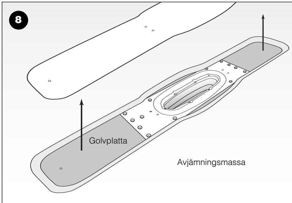
När avjämningsmassan är torr skruva upp de 6 skruvarna och lyft bort ingjutningsfixturen.
