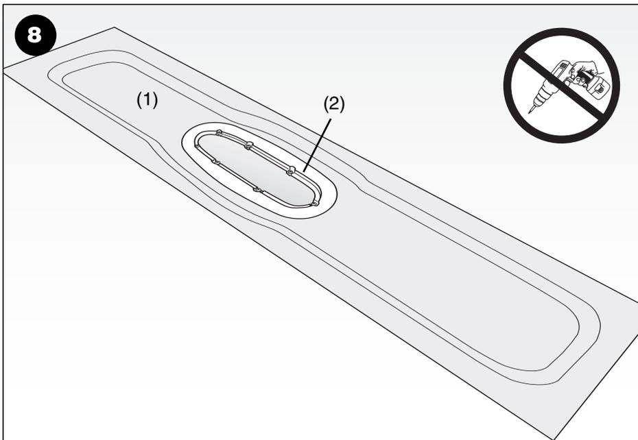
Brunnsmanschetten (1) monteras i rännan och skruvas fast under klämringsovalen (2).
