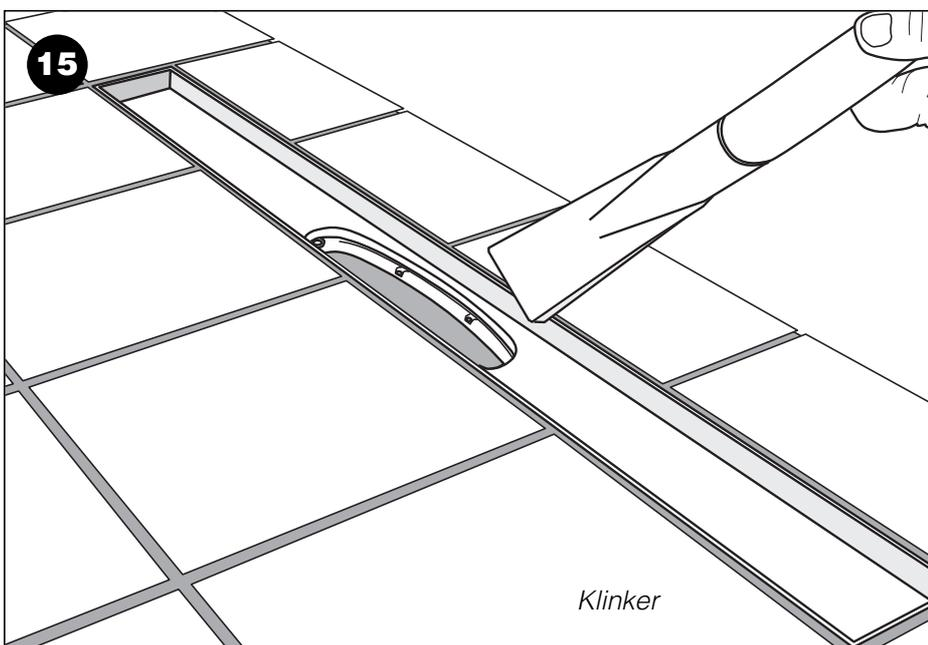
Klinker monteras och ramen fogas med klinkerfog.
