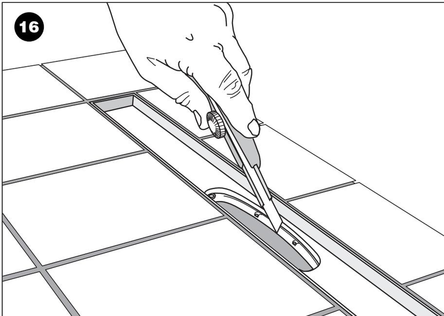
Brunnsmanschetten som fortfarande täcker öppningen ner i brunnen renskärs längs innerkanten på klämringsovalen med en skarp kniv.
