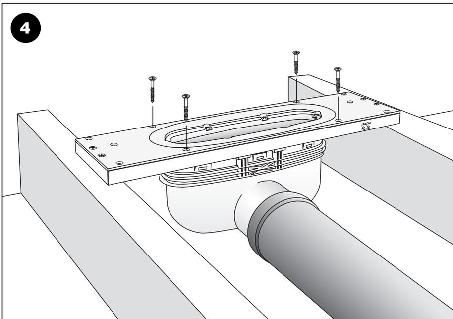
Skruva fast brunnen till monteringsramen där inga regler finns för att förankra plastöverdelen till ramen.
