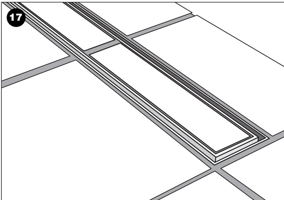
Montera klinker i den inre ramen med fix eller med lämpligt lim för klinker som fäster mot rostfritt.
