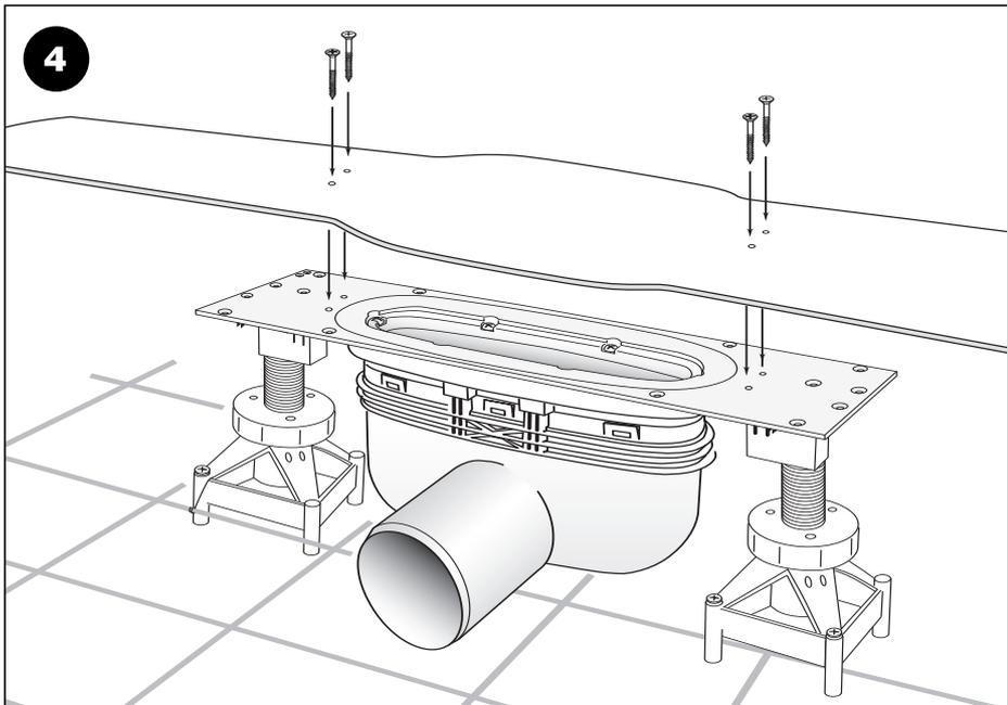
Ingutningsfixturen skruvas fast till brunnen med 4 skruvar. Brunnens höjd och vinkel justeras med PURUS stöden.
