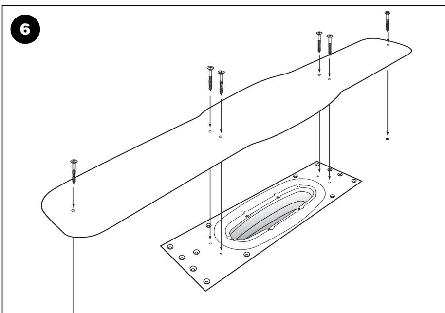
Den medföljande ingjutningsfixturen monteras på golvbrunnen.
