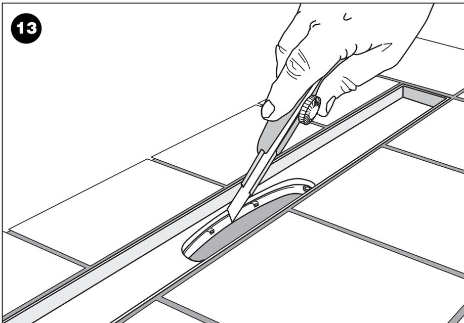
Brunnsmanchetten som fortfarande täcker öppningen ner i brunnen renskärs längs innerkanten på klämringsovalen med en skarp kniv.
