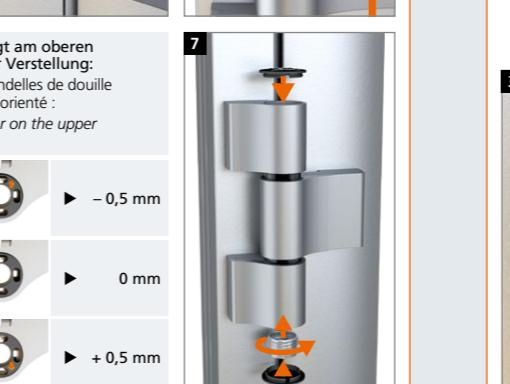
Markierung am Buchsenkragen zeigt am oberen und unteren Rahmenband nach der Verstellung:
