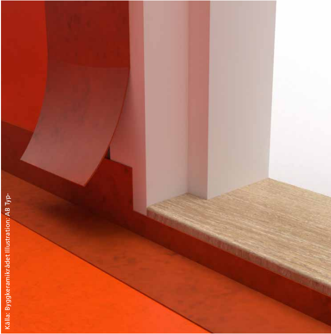
FIGUR c Tröskel i liv med vägg Försegling ska utföras kontinuerligt mellan tröskel, karm och vägg.
