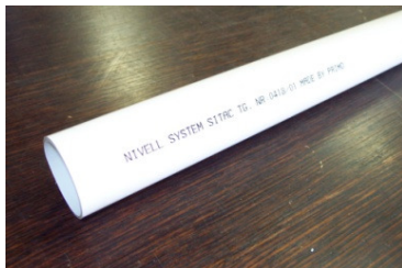
Plaströr art.nr. 220151 och 220152 ø 50,8mm t=1,7mm L=1500mm
