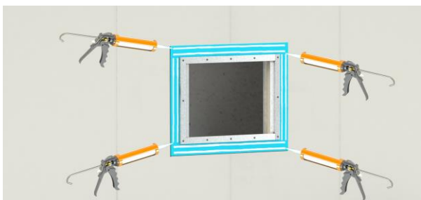
1. Applicera Mira 3690 one-seal på ramens prefabricerade foliefläns.
