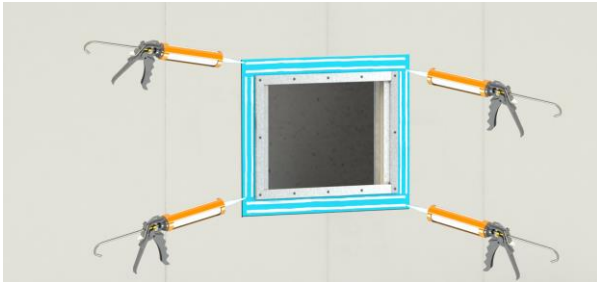
1. Applicera Sopro Racofix 818 på ramens prefabricerade foliefläns.
