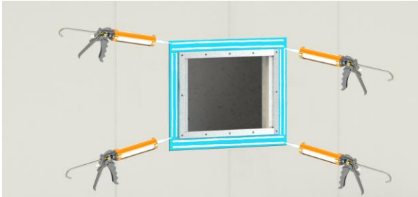
1. Applicera Wetstop Foilseal på ramens prefabricerade foliefläns.
