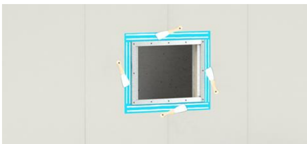
1. Applicera Alfix 2K Tätningsmassa på ramens prefabricerade foliefläns. Använd fintandad limspredare alt. Pensel.
