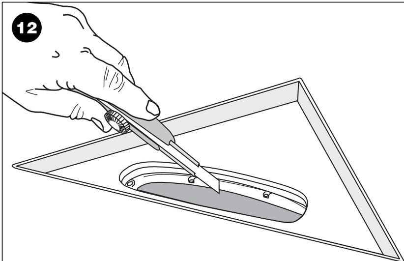
Brunnsmanschetten som fortfarande täcker öppningen ner i brunnen renskärs längs innerkanten på klämringsovalen med en skarp kniv.
