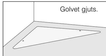
När betonen är härdad, skruva upp de 2 skruvarna och lyft bort ingjutningsfixturen.
