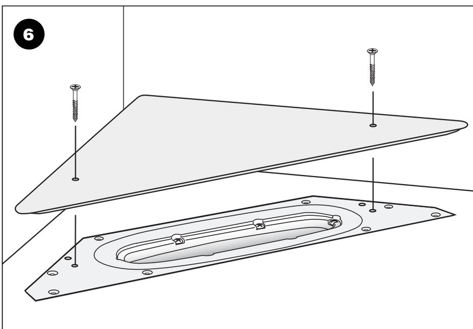
Den medföljande ingjutningsfixturen monteras på golvbrunnen.
