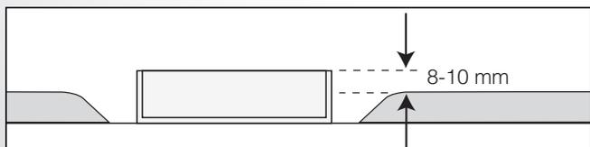
Klinker monteras och ramen fogas med klinkerfog.
