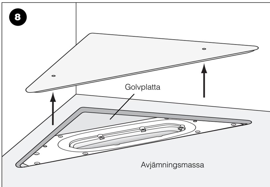
När avjämningsmassan är torr skruva upp de 2 skruvarna och lyft bort injutningsfixturen.
