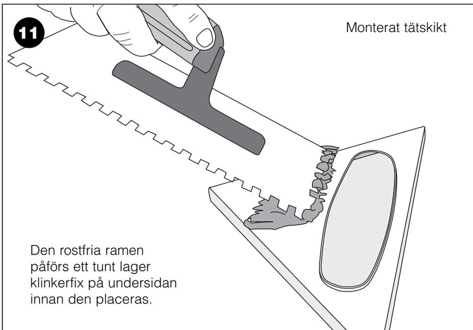
Tätskiktet monteras efter tätskiktsleverantörens monteringsanvisningar.
