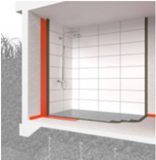
BILD A – Källare med tillskjutande markfukt Krav på tätskikt för golv och yttrevägg är undantaget där risk för tillskjutande fukt föreligger.
