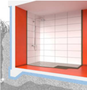
BILD A – Källare med tillskjutande markfukt Krav på tätskikt för golv och yttrevägg är undantaget där risk för tillskjutande fukt föreligger.
